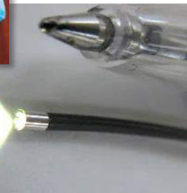
極細径φ1.3mm CMOS内視鏡
