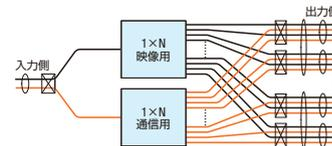
映像用と通信用の 2 心サービスに最適なスプリッタモジュール配線です。加入者のエリアに応じ、スプリッタの分岐数を選択してください。
