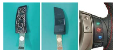
メンブレン製品 (静電容量式スイッチ)
